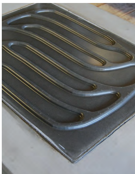
Das bionische Kanalsystem dient der Energiegewinnung. Foto: Fraunhofer Institut für Solare Energiesysteme
